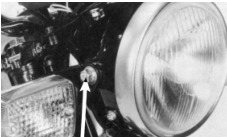
PARAFUSO DE FIXAÇÃO DA CARÇA DO FAROL
